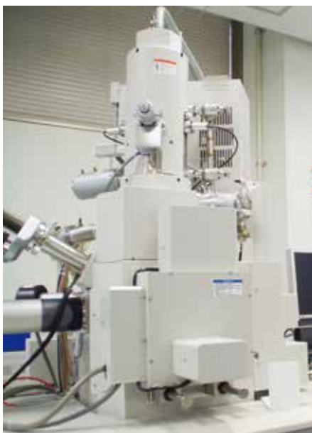
超高分解能電界放大型走査電子顕微鏡（左）とそれを使って観察された竹パウダー内の乳酸菌（右）
