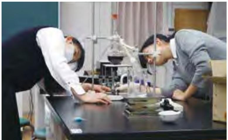
蒸留の様子。エタノールは沸騰させ水は沸騰させないようにするため、丁寧な温度管理が要求されます。
