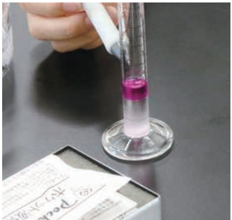
指示薬を使ってエタノールの検出を行った時の様子。赤い部分が生成したバイオエタノール。生徒は生成の難しさを実感した様子。
