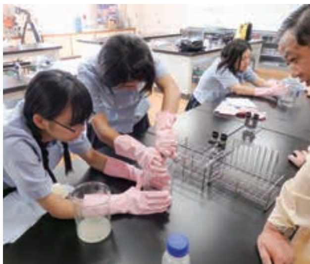
加水分解して生成したと思われるグルコースの水溶液を絞り出している様子。回収率を上げるため全力で絞っています。
